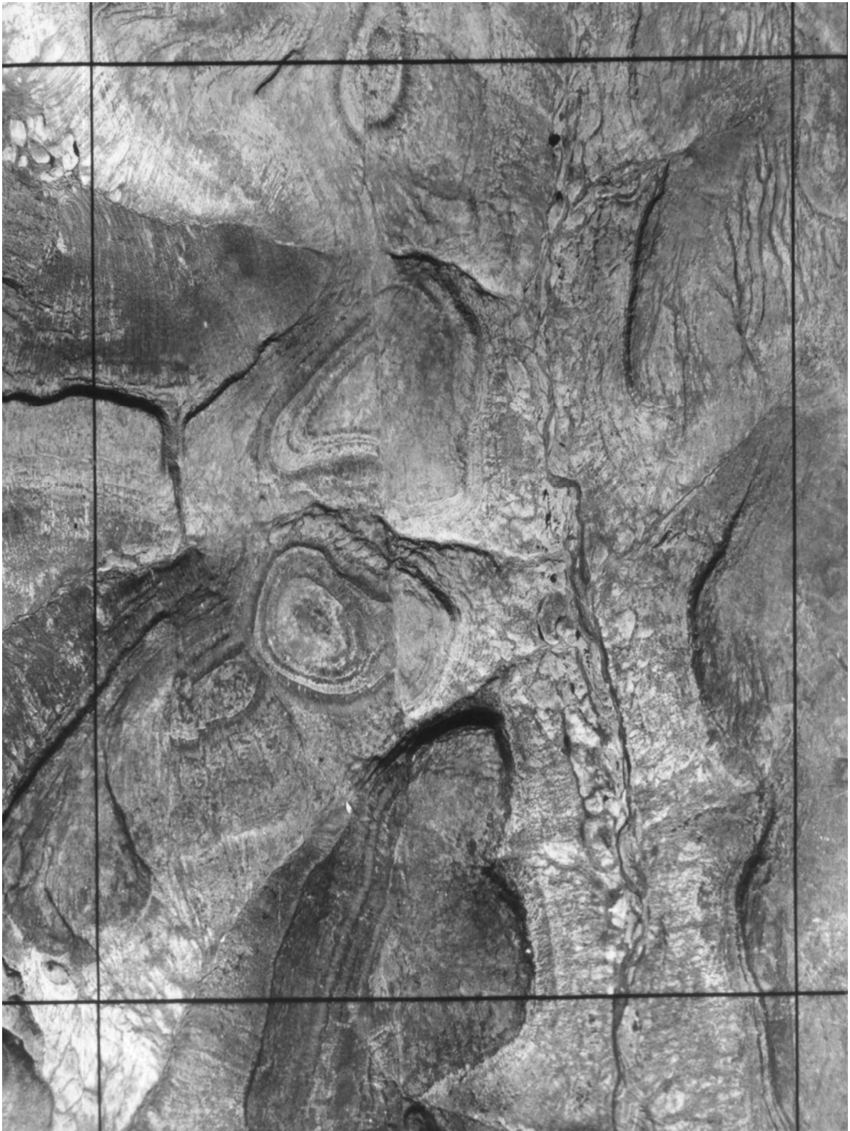
Рисунок 18.2. Регіональний скид у товщі осадових порід, які залягають горизонтально
